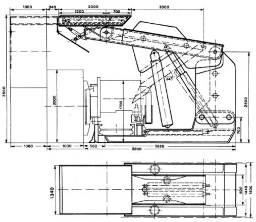
Fig. 2. The VHP750 sublevel caving shield
